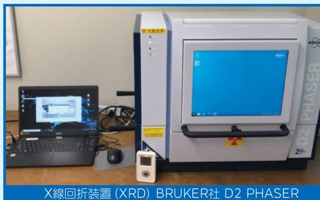
X線回折装置 (XRD) BRUKER社 D2 PHASER
