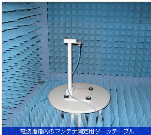
電波暗箱内のアンテナ測定用ターンテーブル
