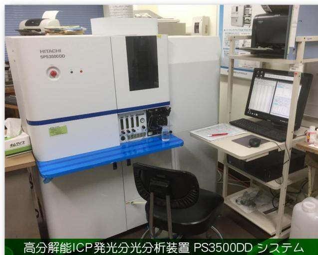
高分解能ICP発光分光分析装置 PS3500DD システム
